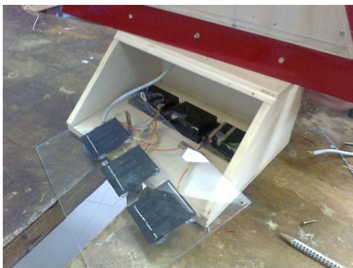
Slika 10: Namestitvev fotocelic na pleksi steklo in na ohišje škatle
